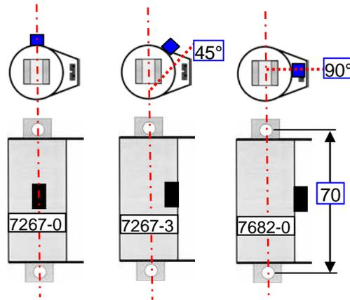
*Zündspule 7267-0, 7267-3, 7682-0: Kern ca.81x11mm. Lochabstand ca.70mm, 2 angelötete Kabel ca.200mm*
