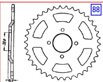
Bei der Kette **1/2x 3/16** ist die innere Breite 4,76 mm - passendes Kettenrad hat eine Breite von ca.4,0 – 4,4 mm
