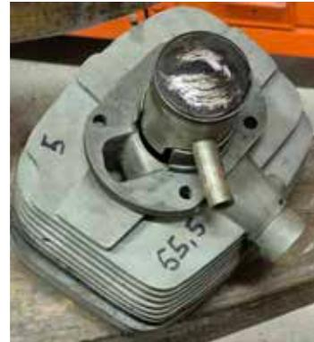
125-G6 Bild 6 Kolben mit Zylinder 54,5 mm, gebraucht (Bundeswehr-Ausbauteil)
