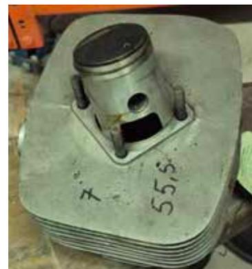
125-G4 Bild 4 Kolben mit Zylinder 55,0 mm, gebraucht (Bundeswehr-Ausbauteil)
