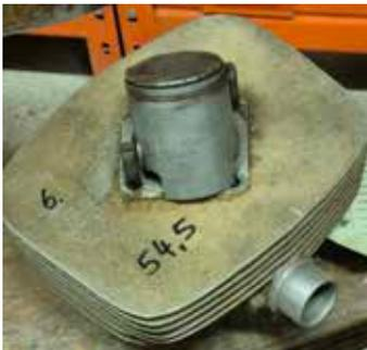
125-G7 Bild 7 Kolben mit Zylinder 55,5 mm, gebraucht (Bundeswehr-Ausbauteil)
