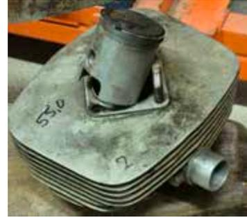
125-G3 Bild 3 Kolben mit Zylinder 54,0 mm, gebraucht1 (Bundeswehr-Ausbauteil)
