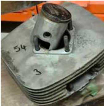
125-G5 Bild 5 Kolben mit Zylinder 55,5 mm, gebraucht (Bundeswehr-Ausbauteil)
