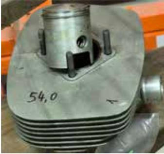
125-G2 Bild 2 Kolben mit Zylinder 55,0 mm, gebraucht (Bundeswehr-Ausbauteil)
